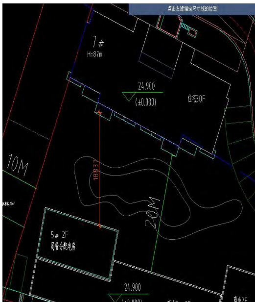
5#局管配电房距离最近的 7#住宅楼 18.8m
