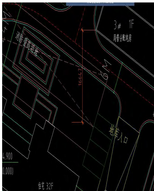
3#局管配电房距离最近的 19#住宅楼 16.6m
