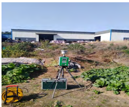
厂界无组织废气下风向
