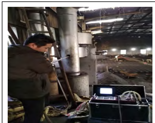
熔炼废气排气筒进口
