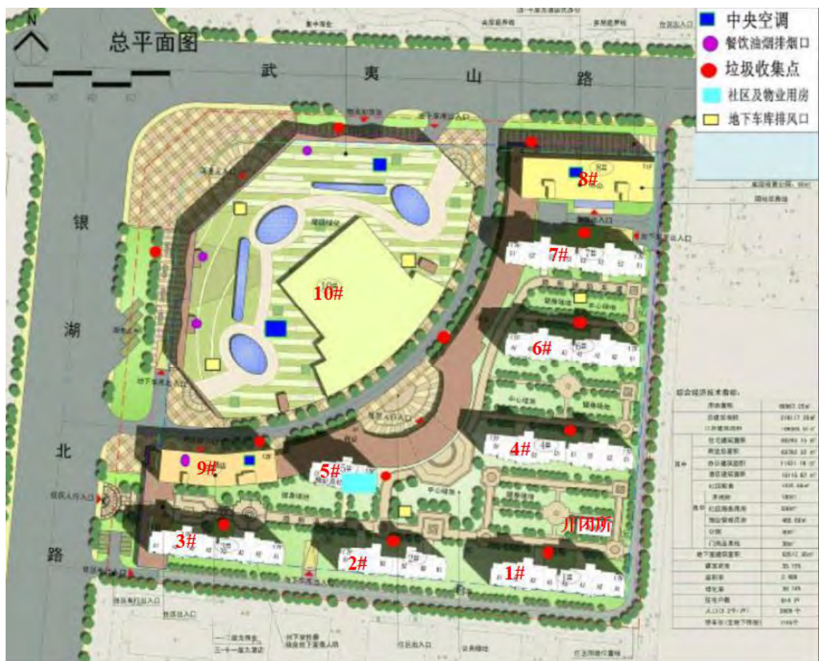
图 3-3 总平面布置图 (本次验收范围: 1~6#、9~10#栋, 开闭所, 地下车库一、二、四, 人防车库一、二、三)
